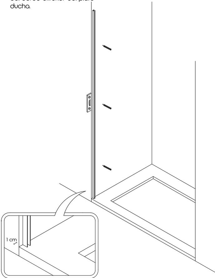
**2** Aplicamos silicona en el interior del perfil "U". Colocamos cristal fijo, nivelándolo correctamente.
