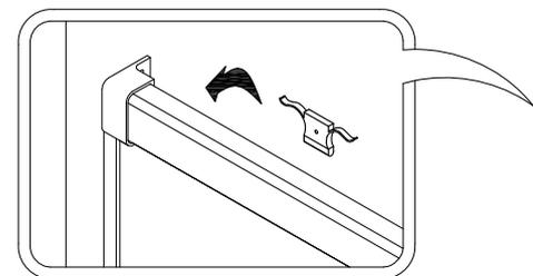
**3** Introducimos freno en la guía. Colocamos guía superior encima del cristal fijo, nivelamos, y atornillamos las cogidas a la pared. Una vez atornillada y a la pared, fijamos cristal fijo a la guía con la pieza de cogida. Seguido, fijamos con silicona la pinza interior al fijo.
