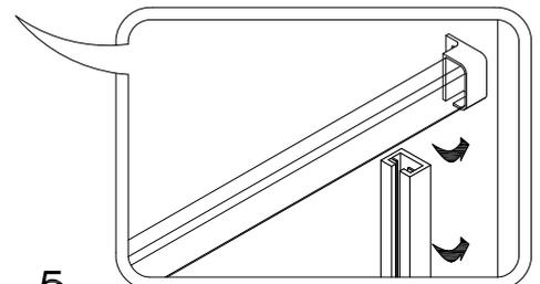
**5** Una vez colocada la puerta graduamos los rodamientos, ajustamos la pinza antivuelco a la pestaña superior de la guía sin que llegue a rozar, para evitar que la hoja pueda salirse del carril, y pegamos el perfil imán a la pared donde nos pida la propia hoja corredera.
