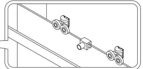
**4** Colocamos los rodamientos en la hoja, y entre los dos rodamientos, la pinza antivuelco. A continuación, la colgamos de la guía superior, introduciéndola por el carril de la guía inferior.
